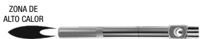
Patrón de llama correcto y estable: llama mínima de 1.3 cm a 2.5 cm
